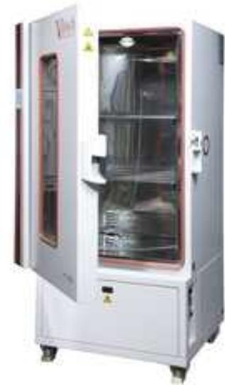
*Kapton #1 roulé @ 30 degrés & 80% humidité*
