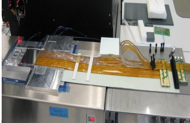
Şekil 3.22: Çipe bağlı olan kabloların diğer uçlarının dedektöre bağlanma işlemi.
