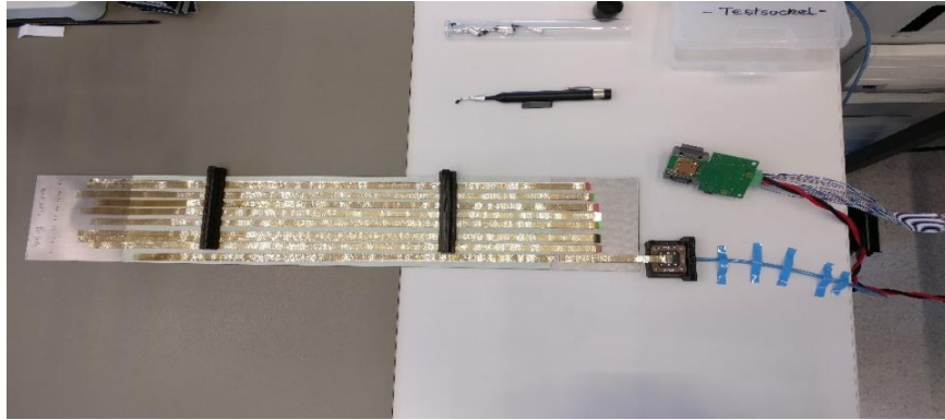
Şekil 3.33: STS-XYTER ASIC ve mikrokablo arasındaki bağlantı testi.
