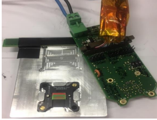
Şekil 3.7: Pogo-pin test istasyonunun eski versiyonu.
