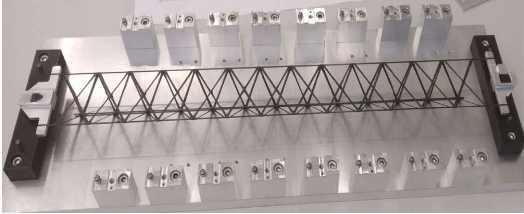
Şekil 2.21: STS modülleri için merdiven.
