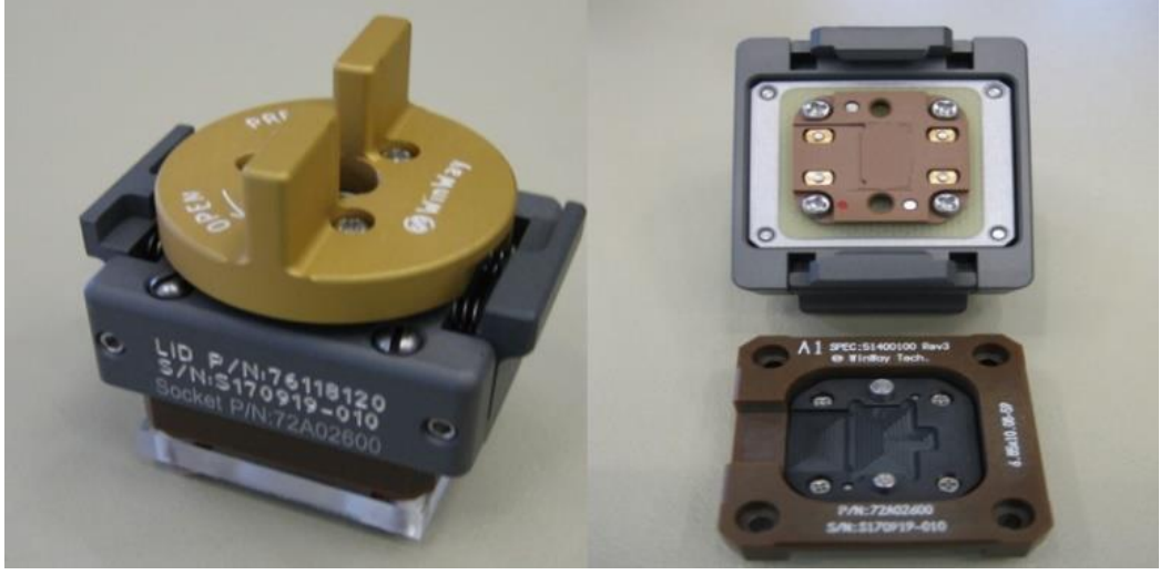
Şekil 3.9: Pogo-pin test istasyonunun yeni versiyonu.
