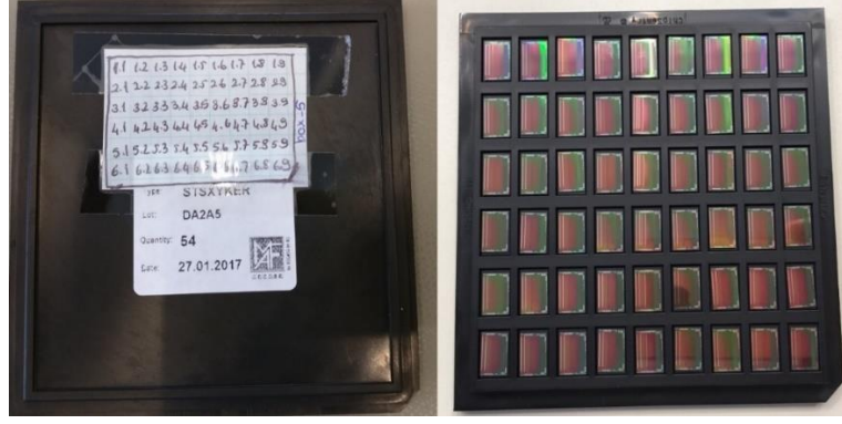
Şekil 3.18: STS-XYTER ASIC ve numaralandırılması.
