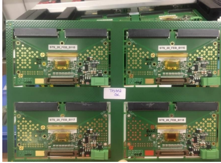
Şekil 4.3: STS-XYTERv2 ile test edilmiş prototip FEB-B için bir örnek.
