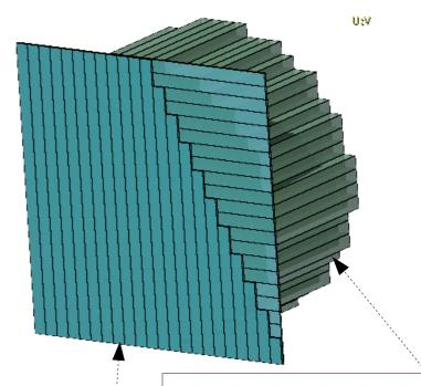
BGO crystals calorimeter (bismuth germanate)
