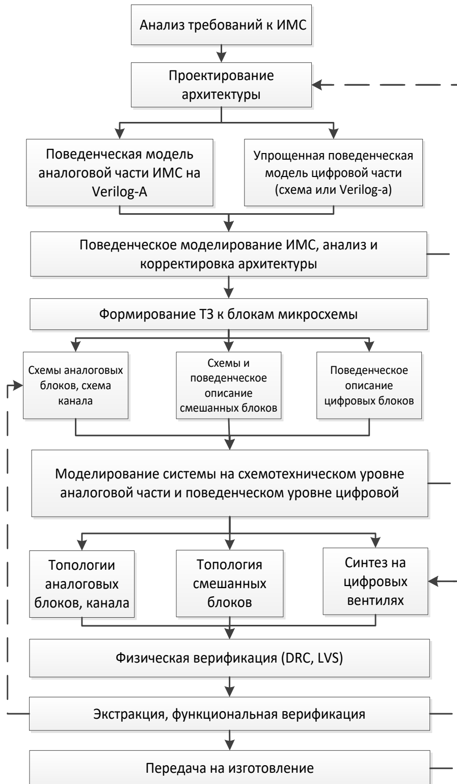
Рис. 1.10 Маршрут проектирования многоканальных СИМС для физических экспериментов
