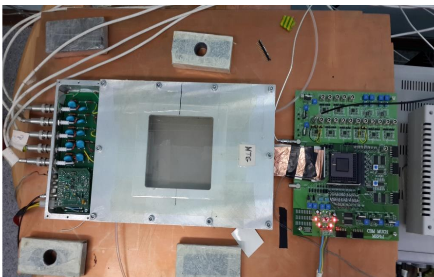
Рисунок 4.3 Стенд для проведения измерений параметров прототипных микросхем совместно с прототипами детекторов
