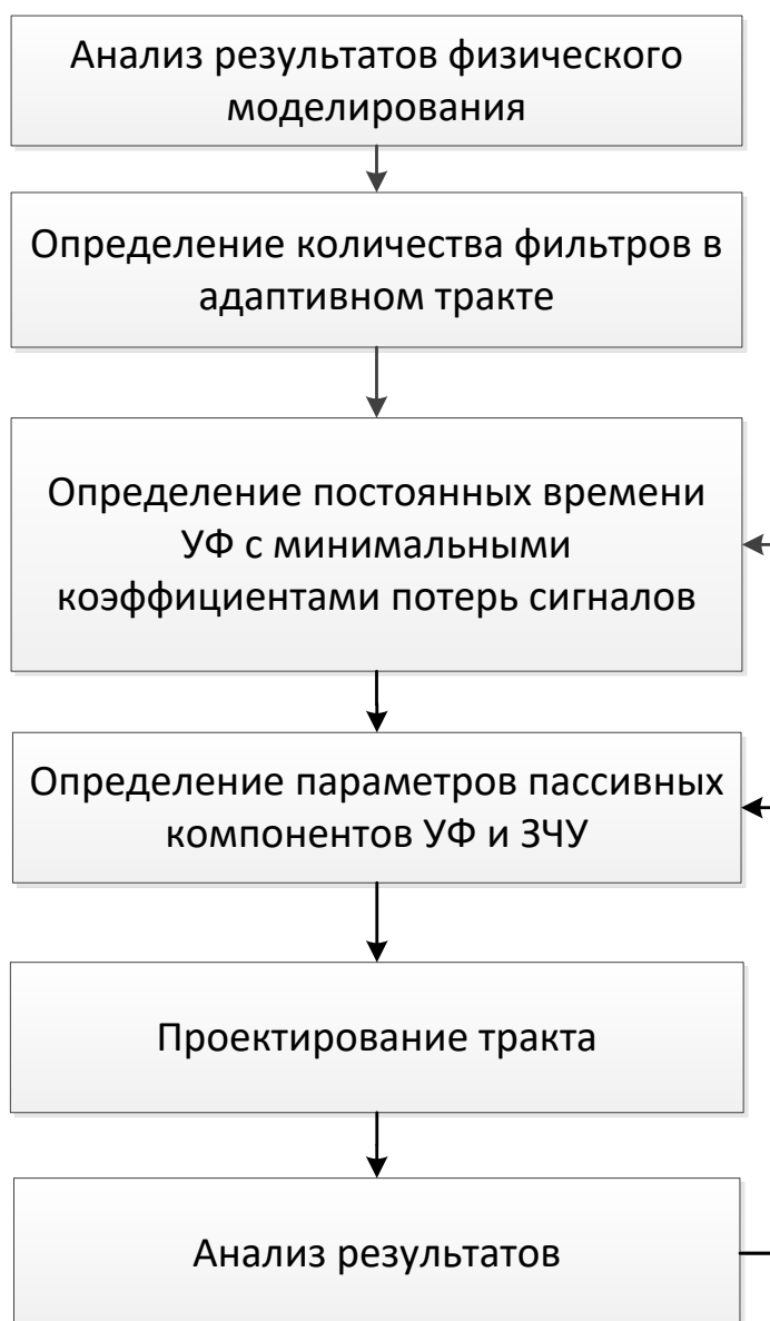
Рисунок 3.1 Методика проектирования адаптивного тракта для считывания сигналов многоканальных ГЭУ
