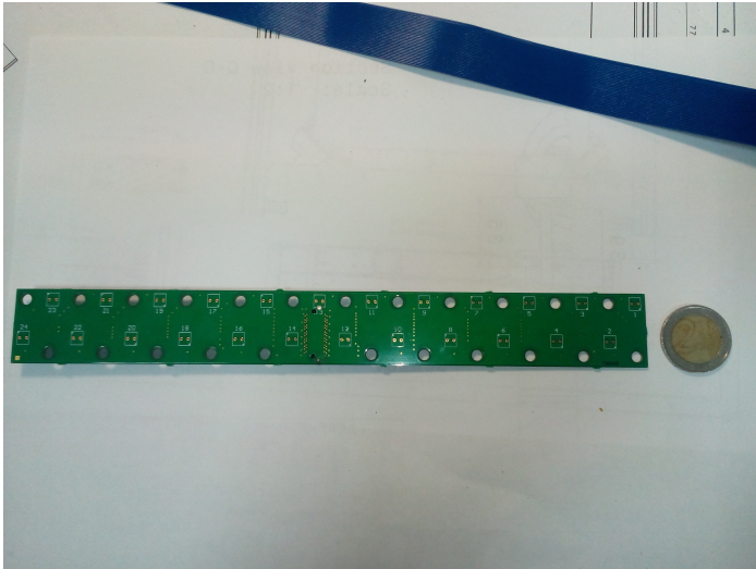
Abbildung: Bild der unbestückten PCB.
