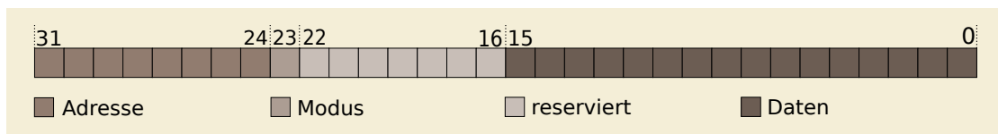
Abbildung 39: Schematische Übersicht des Aufbaus der 32 Bit Daten der SPI Verbindung.
