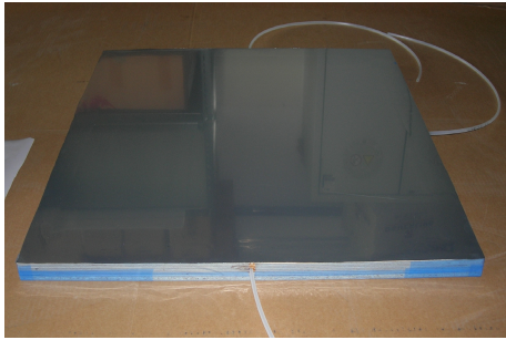
Abbildung 4.3: Testkammer zur Messung der Folienausdehnung
