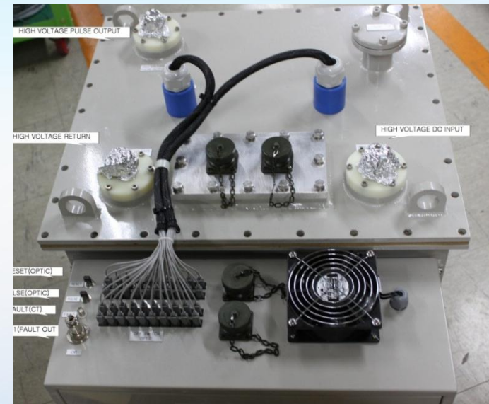
HV switch : 60kV, Dong-A Hitech., Korea
