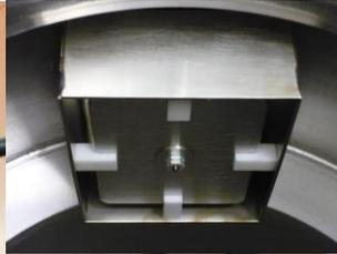
HEST BPMs sind segmentierte Phasensonden mit nicht-linearer Antwort auf Positionsablagen.
