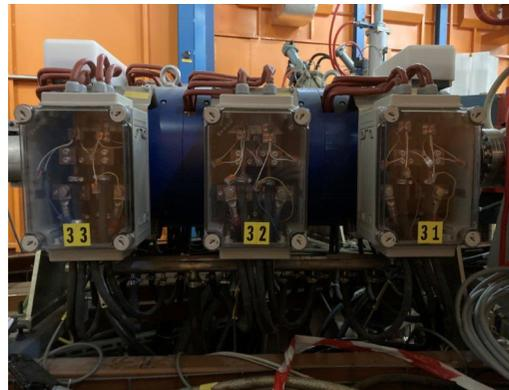
Einbau neue Einkoppelschleife **UA4BA4** mit Anpassung Energieleitung
