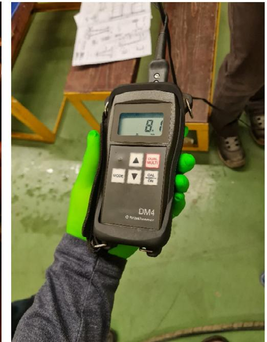
Gerät ist zum Auffinden von Kühlkanälen geeignet
