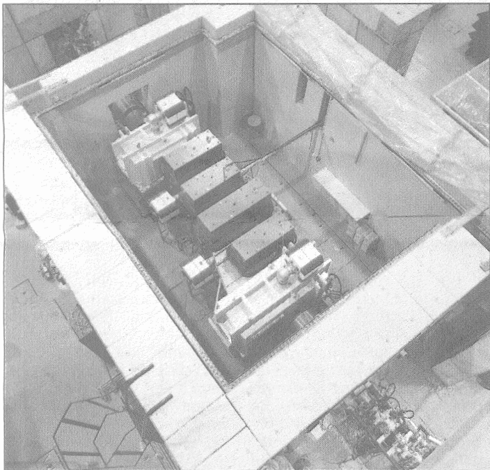
IONENFALLE: Acht Meter lang ist die Kammer, in der vier Magneten im so genannten SHIP (Separator for Heavy Ion Projection) nach der Fusion die Spreu vom Weizen trennen. Dieser Filter sortiert Fehlprodukte aus und lenkt nur bestimmte Ionen zum Detektorsystem.
