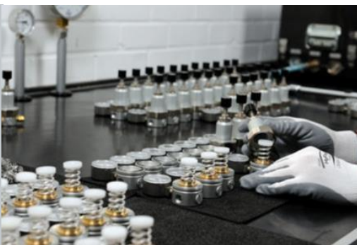
u. a. Präzisionsdruckminderer für eine höchst präzise Druckregelung
