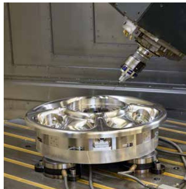
Werkzeugvermessung im Fertigungsprozess an einem aus einer hochwärmefesten Edelstahllegierung gefertigten Spezialbauteil.
