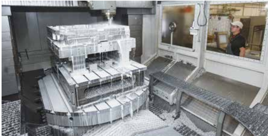
CNC-Fräsen eines großen, kubischen Werkstücks aus hochfester Aluminiumlegierung.
