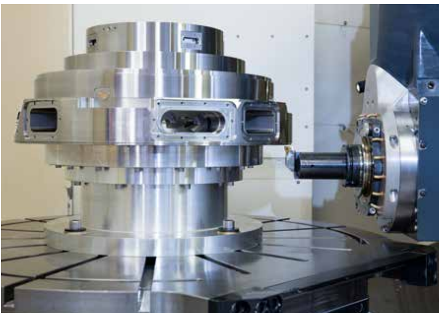
Dieses Fräs-/Drehzentrum mit planliegendem Maschinentisch bietet in einer Aufspannung alle Möglichkeiten der Zerspanung (bis \varnothing 1.250 mm). Die Werkstücke werden präzise ausgerichtet und wie auf einer Karusselldrehmaschine bearbeitet. Zusätzlich können sie 5-achsig gefräst sowie direkt auf der Maschine mit höchster Genauigkeit zu komplexen Baugruppen montiert werden.
