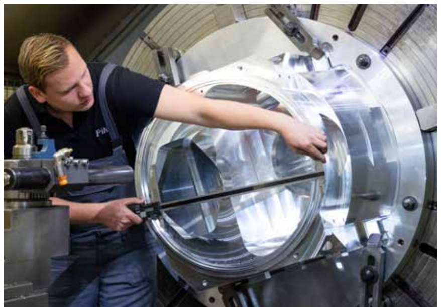
CNC-Drehmaschine für Großbauteile mit komplexen Geometrien.
