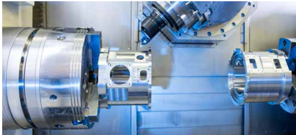
Drehen und Fräsen auf einer Maschine als 6-Seiten-Komplettbearbeitung: Dieses CNC-Bearbeitungszentrum verfügt über eine Haupt- und Gegenspindel für die wirtschaftliche Fertigung von Präzisionsbauteilen.
