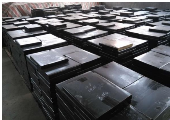
图 5.1 用于制作高计数率 MRPC 的低阻玻璃成品
