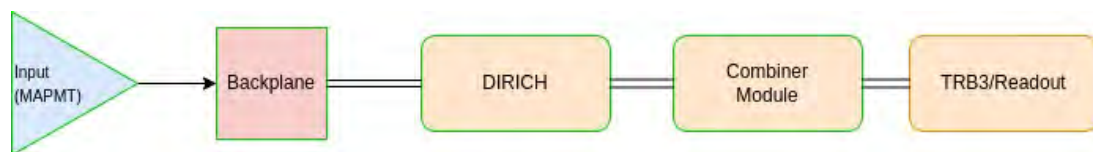
Abbildung 2.1 ♦ Skizze der CBM-RICH-Ausleseketten. In blau ist die Sensorik eingezeichnet. Die Hauptplatine ist in rot und die Ausleseelektronik wird in gelb dargestellt. Mit einer grünen Umrandung sind alle Komponenten eingezeichnet, welche durch eine Steckverbindung verknüpft sind.
