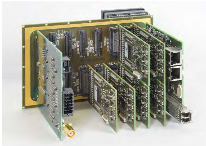
Abbildung 2.2 ♦ Rückseitige Ansicht der Front-End-Elektronik. Auf der linken Seite ist das Modul für die Spannungsversorgung, mit einem 3-Pin-Anschluss oben, einem 24-Pin-Anschluss in der Mitte und einem Hochspannungsanschluss unten. In Zweierreihen in der Mitte sind die DIRICH-Auslesemodule. Ganz rechts ist das Kommunikationsmodul mit zwei Ethernet- und einem Glasfaser-Anschluss.[GSI22]
