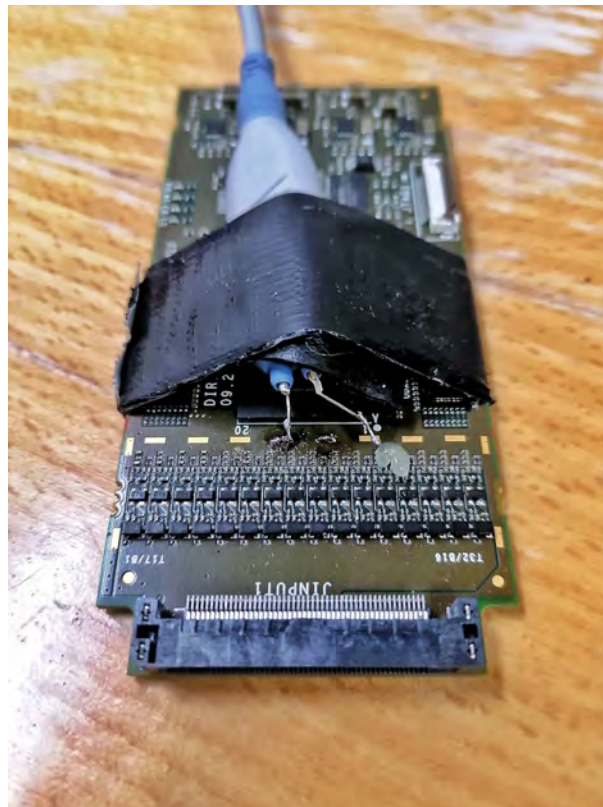
Abbildung 3.5 ♦ Bild eines DIRICH mit montierter Aktivprobe. Im Vordergrund sind der Konnektor und die Reihe der Vorverstärker zu sehen. Die Fühler der Probe sind dahinter an die SMD-Bauteile verlötet worden. Der Probenkopf selbst wurde mit Faserband auf dem Haupt-FPGA befestigt. Im Hintergrund ist der weiße Anschluss zu sehen, mit welchem die FGAs auf dem DIRICH programmiert werden können.
