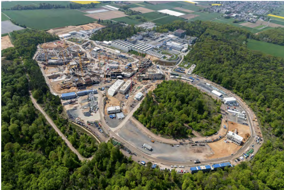
Abbildung 1.1 ♦ Luftbildaufnahme der Facility for Antiproton and Ion Research (FAIR) Baustelle nahe Darmstadt. Auf der rechten Seite wird der Beschleunigerring SIS100 gebaut. Detektorgebäude und Administration befindet sich links im Bild. Oben im Bild sind die Gebäude der Gesellschaft für Schwerionenforschung (GSI) zu sehen. [GSI22]
