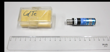
EURORAD, Ohmic type 10mm×10mm×3mm
