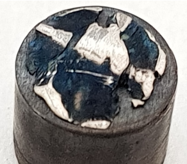
Bessere Ausbreitung auf U-Metall als AgPd oder InCuAg Dunkelblaue Oxidschicht
