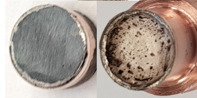
Oben: Lot an Tiegelwand hochgezogen Unten: am Boden leichte Verklebung, kaum Kontakt
