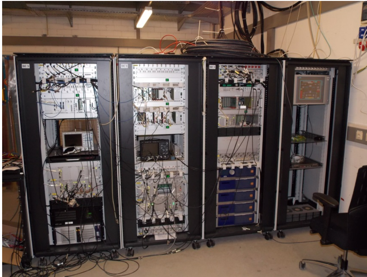
Ring-HF-Versorgungsraum im BG1.016: LLRF-System der SIS18-h=2-Kavität (Rackreihe für eine der drei Einheiten)
