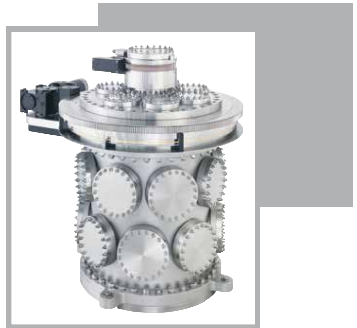
Vakuummesssystem für die Grundlagenforschung (Leckrate von \leq 10^{-9} mbar \times l/s) u.a. mit 2-fach differentiell gepumpten Drehdurchführungen DN 160 CF und DN 500 COF sowie einem Wegmesssystem (Winkelgenauigkeit 0,001^\circ ), motorisiert mit Schrittmotor (Drehgeschwindigkeit \sim 0,5 U/min).
