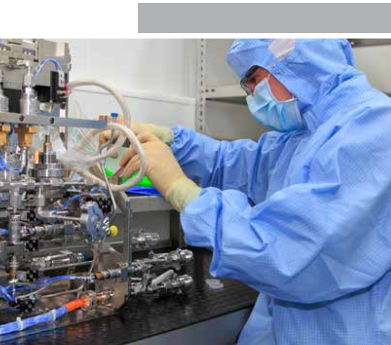
Reinraum-Montagearbeiten an der Ultrahochvakuumkammer des Materialforschungsmoduls EML.
