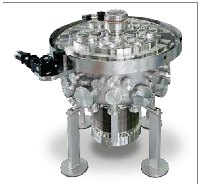
Diese Experimentierkammer für das DynaMax-Projekt (BESSY II) mit Drehdurchführungen DN 800/850 COF und DN 160 CF dient der Grundlagenforschung mittels zeitaufgelöster Experimente im 100fs-Bereich (Winkelauflösung der Drehdurchführung: \leq 0,001^\circ pro Motorschritt).
