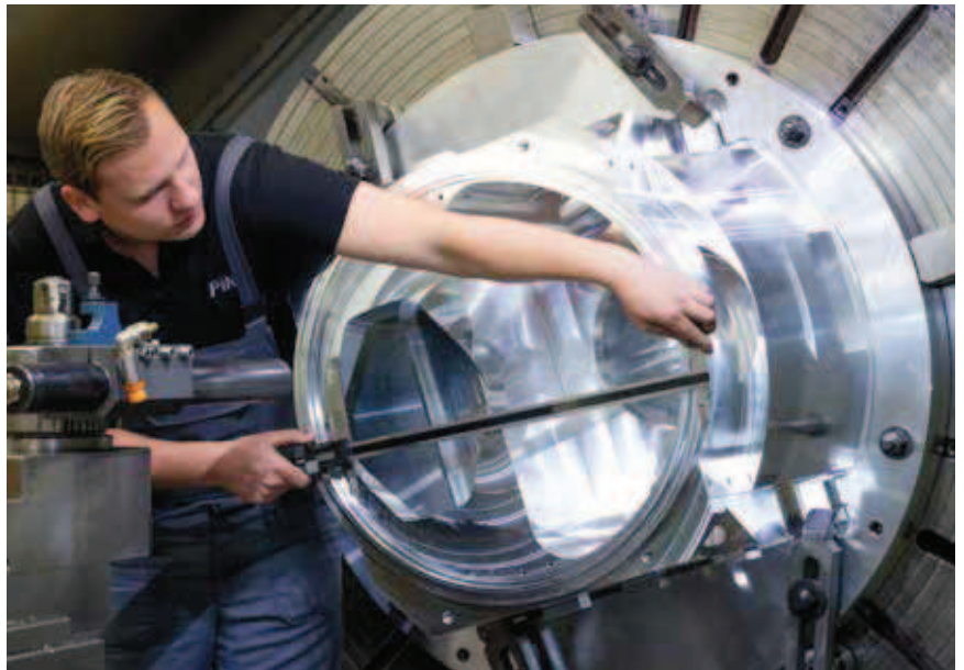
CNC-Drehmaschine für Großbauteile mit komplexen Geometrien.
