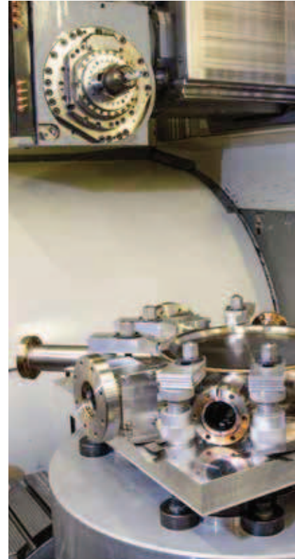
Finale Endbearbeitung von komplett montierten Baugruppen mit hoher Präzision ( \pm 0,005 mm).
