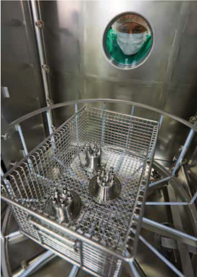
Diese von PINK entwickelte Vakuum-Reinigungs- und Trocknungsanlage ist für den vollautomatischen Betrieb ausgelegt.
