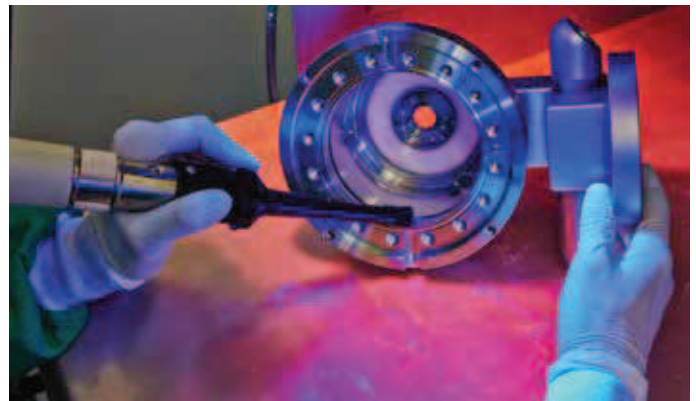
Die Kontrolle auf Partikelfreiheit erfolgt u.a. mit UV-Weiß- und Schwarzlicht-Systemen.
